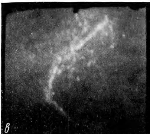
Фиг. 7. Увеличенные кадры киноплёнки, обозначенные на фиг. 6 буквами: a и в — в начале и в конце полного периода вращения в верхнем створе, б — среднее, переднее положение жгута
