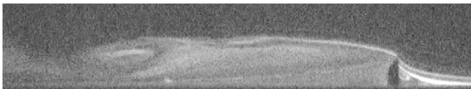
Рис. 3. Дымовая визуализация обтекания выступа при Re_h = 150 [1].
