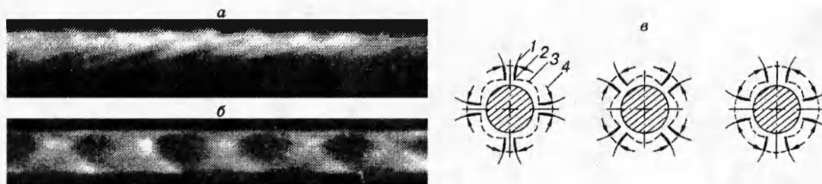
Рис. 2. Детонационные волны, снятые через радиальное окно методом компенсации скорости (а), развертка движущихся волн, снятая через щель, перпендикулярную окнам (б) и интерпретация процесса сжигания смеси в плоскости кольцевого слоя (в) (здесь 1 — ударные волны, 2 — детонационные фронты, 3 — контактные разрывы, 4 — направление движения волн)
