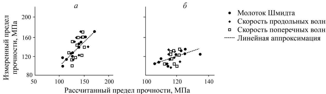
Рис. 6. Сравнение рассчитанного и измеренного предела прочности на одноосное сжатие для пластов Сакесар (а) и Намал (б)
