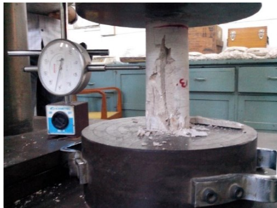
Рис. 3. Разрушение образца при измерении предела прочности на одноосное сжатие испытательной машиной Shimadzu
