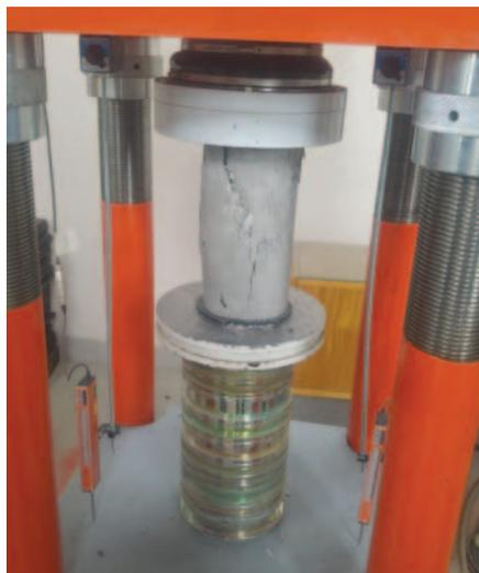
Рис. 1. Эксперимент на сжатие цилиндрического образца, изготовленного из бетонной панели
