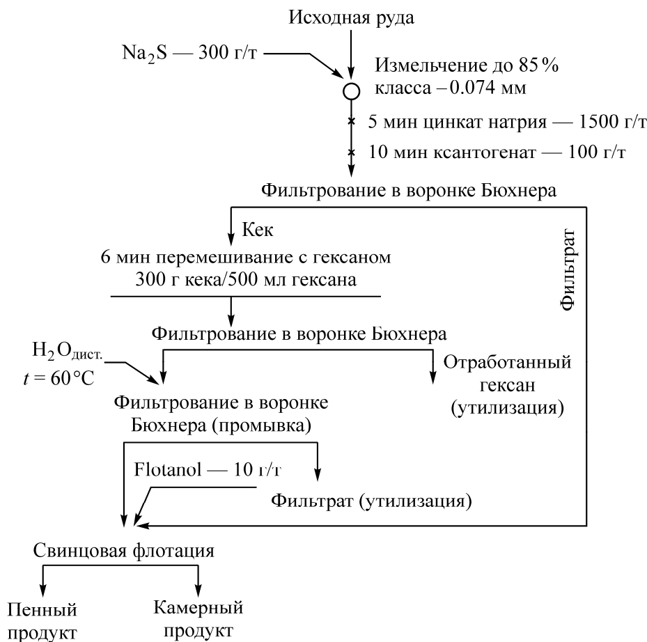
Рис. 3. Опытная схема подготовки свинцово-цинковой руды к флотации с удалением десорбируемой части минерального покрытия
