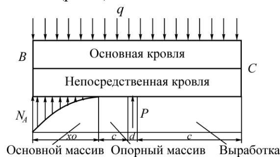
Рис. 3. Эпюра напряжений в сечении B перед вторым разломом
