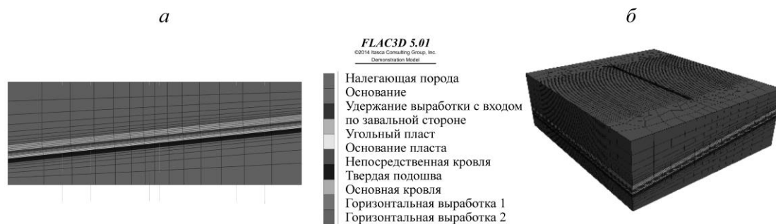
Рис. 5. Трехмерная модель в программе FLAC3D : a — поперечный разрез; б — трехмерный вид
